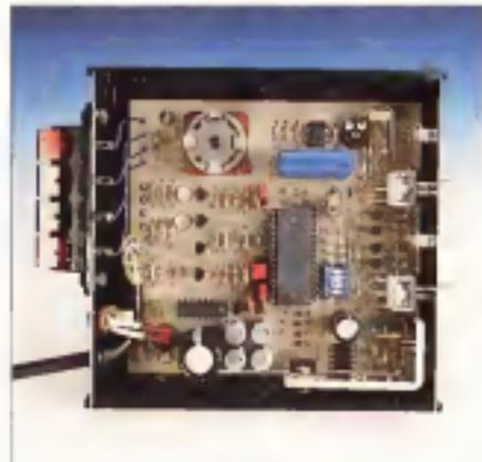
Come per la foto nella pagina a fianco sopra: sotto a due Communicator per Cxt ed IBM sopra: rispetto ai modelli dell'altra serie si nota il diverso stile dell'incasso ed i jumper di configurazione (rossi). Tutte le macchine in prova sono versioni «standard»: quelle di produzione finale avranno sugli stampi la verniciatura dei componenti.
